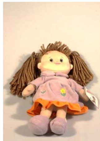
Bild 2 Puppe „Laura“ Mangel: Schleifen lösen sich bei Zugprüfung
