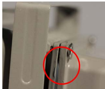
Bild 7 fehlerhaft montierte Dichtung
