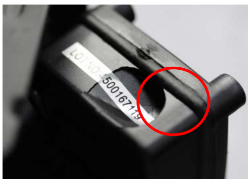
Bild 12 Schaden am Gehäuse nach mechanischer Prüfung
