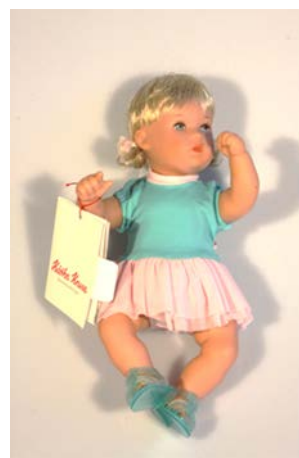
Bild 4 Puppe „Planscherle Belle“ Mangel: Zopfband passt in Kleinteilezylinder
