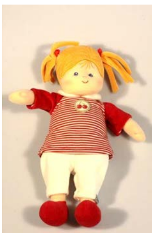
Bild 3 Anziehpuppe „Franka“ Mangel: Haarschleife bei Zugprüfung abgerissen
