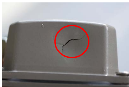
Bild 9 Der Schutz gegenüber Strahlwasser nach IP 65 ist nicht mehr gegeben.
