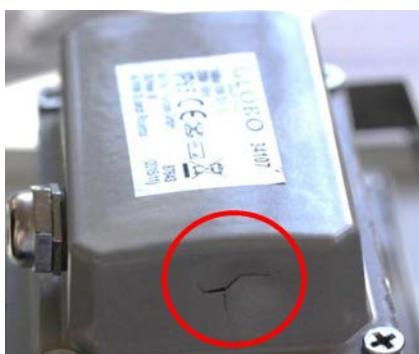
Bild 8 Schaden am Gehäuse nach mechanischer Prüfung
