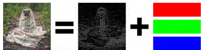
Abbildung 1: Darstellung der Trennung eines Bildes (links) in Kanten (Mitte) und die drei RGB-Farbkanaäle Rot, Grün und Blau (rechts).
