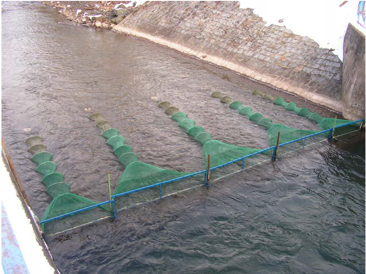
Abbildung 4: Reusenbarriere mit 5 Reusen
