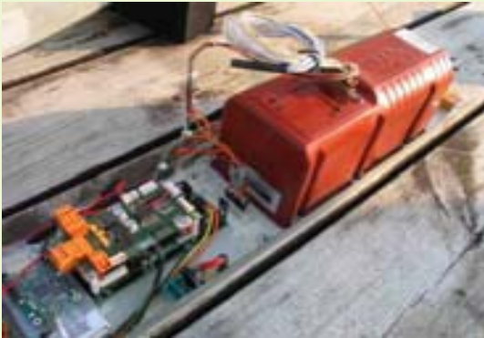
Versuchsaufbau: MINC und FOG-IMU
